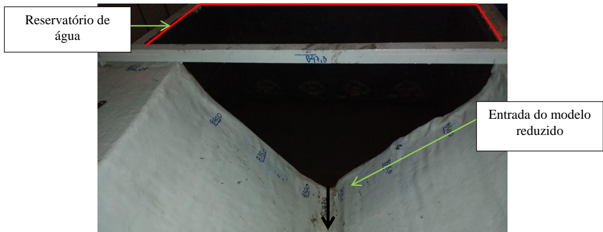
Figura 11 - Reservatório de água que alimentou o modelo reduzido
